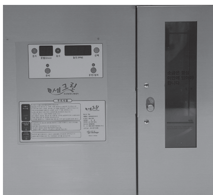
그림 소형 경량화된 전기분해식 대용량 살균수제조장치 SSG-1600
