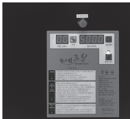
그림 다농도 일체형 희석식 살균수제조장치 SSD-840
